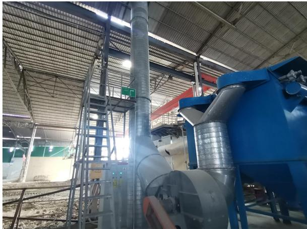
图1 破碎粉尘废气排气筒 DA001
